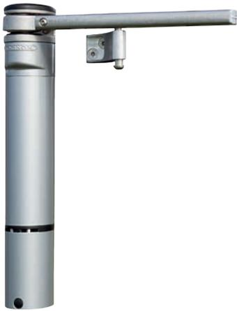
Der Verticlose ist ein hydraulischer Türschliesser wobei Geschwindigkeit, Kraft und Endschlag einfach einstellbar sind, auch nach der Installation. Besonders für Aussenanwendung entwickelt und aus rostbeständigen Materialien gefertigt. Entworfen für Kombination mit 180° Torbändern. Äusserst einfache Montage mittels Bohrvorlage und Quick-Fix. Dank des patentierten Dämpfungsystems ist seine Wirkung unempfindlich gegen Temperaturschwankungen.
