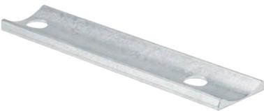
Ausgleichsblech von Vierkant- auf Rundprofilen für SH-Anschläge. Das Blech wird montiert zwischen dem Anschlag und dem Pfosten. So bekommen Sie einen perfekten Anschluss an Rundrohre mit Durchmesser  $\varnothing$  60 mm.
