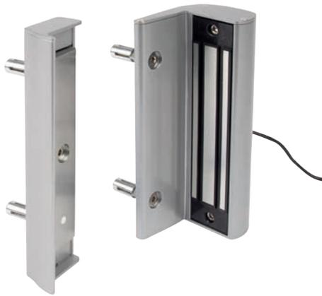
Magnetschloss ohne Drücker. In 2 Versionen verfügbar: Der MAGMAG2500 mit 250 kg Anziehungskraft und der MAGMAG5000 mit 500 kg Anziehungskraft. Das pulverbeschichtete Aluminium-Gehäuse mit einzigartiger Quick-Fix-Befestigung sorgt für eine einfache und schnelle Montage. Sparen Sie sich die zeitraubende Schweissarbeit. Es reicht 5 Löcher zu bohren, um den Mag zu befestigen. Doppelte Schutzschicht, die eine langjährige wartungsfreie Verwendung im Aussenbereich gewährleistet.
