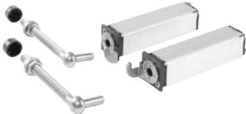
Torbandsfeder für Gartentore. Dieser Set kann einfach in einen Rahmen von 40x40 mm eingeschoben werden. Die Kraft lässt sich leicht einstellen mittels eines Innensechskantschlüssels.
