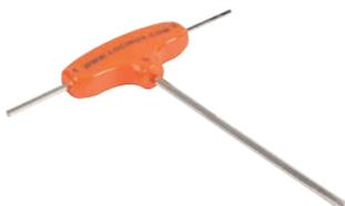
Montagewerkzeug für Torschliesser. Mit dem Innensechskantschlüssel M3 kann man die Kraft und Geschwindigkeit des Samsons einstellen. Mit dem Innensechskantschlüssel M4 wird der Kraft der Verticlose eingestellt und mit dem Innensechskantschlüssel M5 werden die Quick-Fix-Schrauben einfach befestigt.
