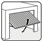
Garagentor lässt sich durch waagerechten Zug oder Druck an der Toroberkante öffnen und schließen.
