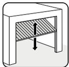
Nichtausragendes Tor, das im Rahmen in einer senkrechten Schiene geführt wird.
