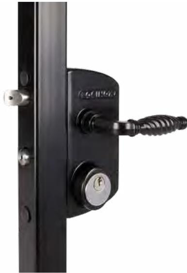
Hochwertiges Torschloss mit Aluminiumgehäuse und Edelstahlmechanismus. Für Kombination mit Einsteck-Profilzylinder entwickelt. Dank der Möglichkeit die Riegel um 10mm zu verstellen, können Sie das Schloss genau auf den Anschlag einstellen und so für eine optimale Verriegelung sorgen. Eine massive Edelstahl-Tiefenverriegelung von 23 mm sorgt für einen sicheren Verschluss. Wird in RAL9005 mit Zamak-Stilldrücker geliefert und in Farbe Silber mit Aluminium-Drücker.
