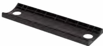
Ausgleichsblech von Vierkant- auf Rundprofilen für SA-Anschläge. Das Blech wird montiert zwischen dem Anschlag und dem Pfosten. So bekommen Sie einen perfekten Anschluss an Rundrohre mit Durchmesser  $\varnothing$  60 mm.
