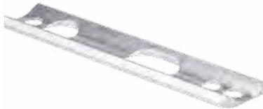
Ausgleichsblech von Vierkant- auf Rundprofilen für Schlösser. Das Blech wird montiert zwischen dem Schloss und dem Profil. So bekommen Sie einen perfekten Anschluss an Rundrohre mit Durchmesser  $\varnothing$  42 mm.
