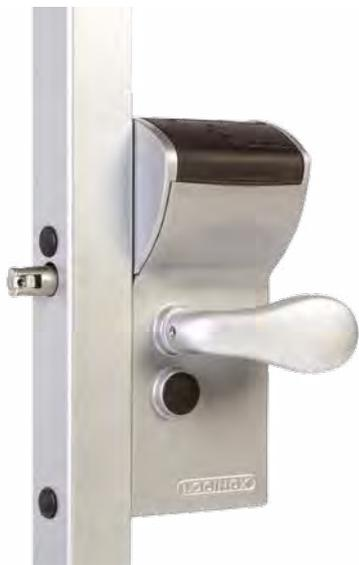
Mechanisches Codeschloss mit Aluminium-Gehäuse und Edelstahl-Mechanismus. Eine Seite mit Code gesichert, andere Seite frei zugänglich. Dadurch, dass dieses Schloss ohne Strom oder Batterie funktioniert, bietet es eine einfache und schnelle Lösung für Tore mit Zugangskontrolle. Dank der 20 mm kontinuierlichen Riegelverstellbarkeit können Sie das Schloss massgenau einstellen für eine optimale Verriegelung.
